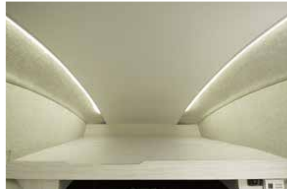
バンクベッド 操作性に優れた跳ね上げ式バンクベッド。 快適な睡眠をお約束します。 拡張時のベッドサイズは1,900mm × 1,320mm 空間の高さは200～660mm 手前から550mmまでの部分は跳ね上げ可能です。
