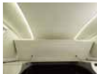
バンクベッド 操作性に優れた跳ね上げ式バンクベッド。 快適な睡眠をお約束します。 拡張時のベッドサイズは1,900mm × 1,320mm 空間の高さは200～660mm 手前から550mmまでの部分は跳ね上げ可能です。
