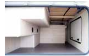
ベッド下外部収納 後部ベッド下外部にキャンプ道具など外から出し入れが便利な収納スペースがあります。 幅は、一番奥140mm 中央部950mm 手前1,290mm 奥行きは、右一番奥まで1,920mm 中央部1,500mm 左側835mm 高さは、左端280mm 中央から右側部分680mm
