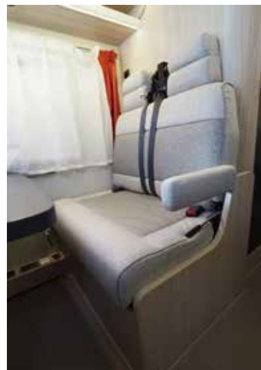
サードシート サードシートには3点式シートベルトを装備。 座面をスライドさせてリクライニング可能。
