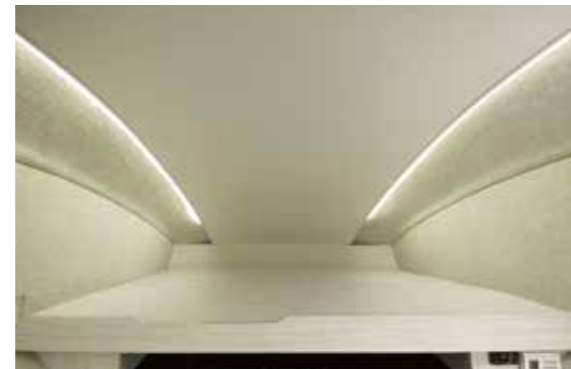
バンクベッド 操作性に優れた跳ね上げ式バンクベッド。 快適な睡眠をお約束します。 拡張時のベッドサイズは1,900mm x 1,320mm 空間の高さは200~660mm 手前から550mmまでの部分は跳ね上げ可能です。
