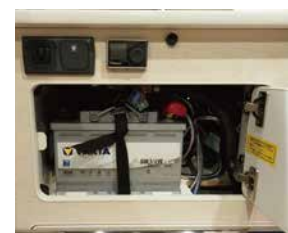
走行充電機能付サブバッテリー、 AC100Vソケット※、 インバーター(400W)※、 FFヒーターコントローラー※
